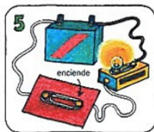
**5** Une un extremo de un tercer cable al terminal libre de la batería. Enrolla el otro extremo alrededor del pasador libre sobre el portabombillas. Se enciende de este modo.
