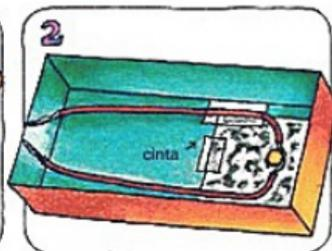
Enrolla las puntas de dos piezas de cable alrededor del pasador. Dobra hacia atrás las puntas por debajo de la caja y cubre con cinta. Pega el cable con cinta adhesiva, como se ve en el dibujo.
