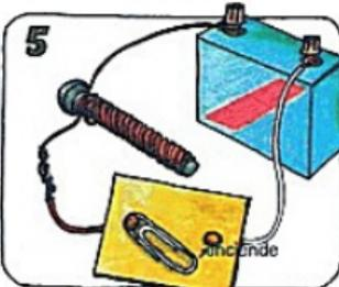
Enrosca el otro cable alrededor de un alambre en el electro-imán. Une la punta del alambre libre del perno al segundo terminal de la batería.
