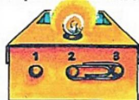
Para comprobar que el transmisor funciona bien, sostén un clip a través de los Terminales 2 y 3 al final de la caja. Presiona el conmutador y la bombilla se encenderá.
