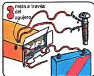
Mete las dos piezas de cable del electro-ímán a través del agujero superior y sácalas a través del final de la caja. Une la punta de un cable a un terminal de la batería.
