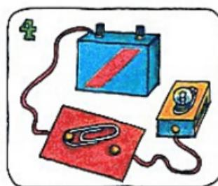
**4** Une el extremo suelto de un cable al terminal de una batería. Enrolla el extremo del otro cable alrededor de un pasador sobre el portabombillas.
