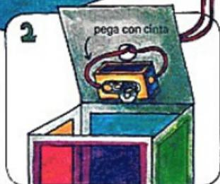
Une un extremo de cada cable largo a un pasador en el portabombillas. Introduce el cable a través del agujero de la tapa. Sujeta el portabombillas a la tapa con cinta.
