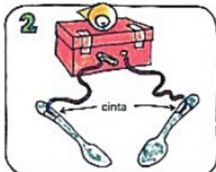
Pega con cinta una punta desnuda de cada trozo de cable al mango de cada cucharita. Asegúrate de que el interruptor de la lámpara está apagado antes de hacer las pruebas.
