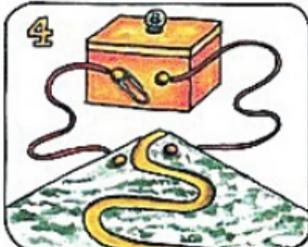
Une las otras terminaciones de las dos piezas de cable a los dos pasadores en la Lámpara de Noche. Asegúrate de que la Lámpara de Noche esté desconectada.
