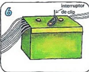
Mete un tercer pasador a través de un clip y luego mételo a través de la tapa de la caja. Dobla hacia arriba una punta del clip para hacer un mango.
