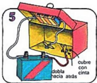
Enrosca la punta de un tercer cable alrededor del pasador libre. Une la otra punta al terminal libre de la batería. Dobra hacia atrás las puntas de los pasadores y cúbrelos con cinta.
