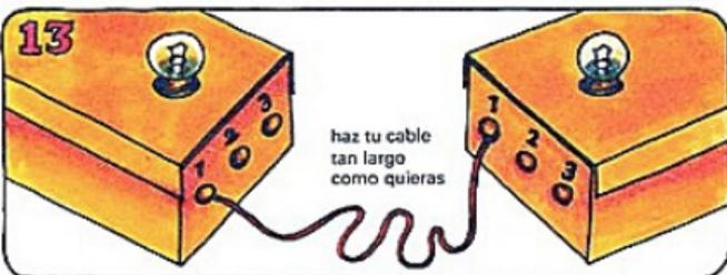
Pon los dos transmisores uno enfrente del otro, como se ve en el dibujo. Enrolla una punta de un cable largo alrededor del Terminal 1 en una caja.
