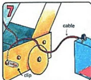
Introduce un segundo pasador a través de un clip y de la caja, cerca del primer pasador. Junta una punta de un nuevo cable a él y la otra punta a la batería.
