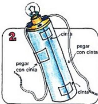
2 Enrolla la cartulina alrededor del portabombillas, con el cable por fuera, como indica el dibujo. Pega el rollo con la cinta y luego pega el cable al tubo de la cinta.
