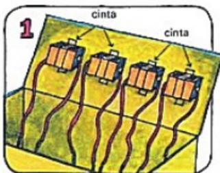
Une el cable a cada pasador de los cuatro portabombillas. Haz cuatro agujeros en la tapa de la caja y mete a través de ellos las bombillas. Fija los portabombillas en su sitio con cinta.
