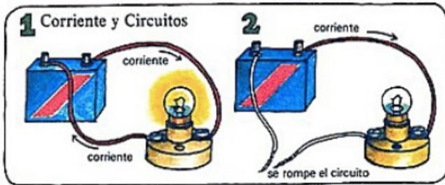
La luz se mantiene cuando la corriente eléctrica corre a lo largo del cable a través de la bombilla y devuelve a la batería. Este camino se llama un circuito.
