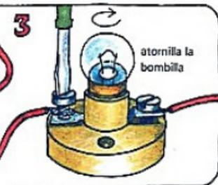
Enrosca los dos tornillos fuertemente, girando el destornillador, como se ve en el dibujo. Los tornillos siempre se fijan de esta manera. Pon la bombilla girando igual.
