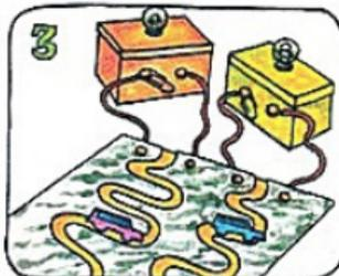
Une los cables de un lado y los pasadores de en medio a las dos Lámparas de Noche, como se ve en el dibujo. Haz dos coches con dos clips. Los conductores necesitarán un imán cada uno.
