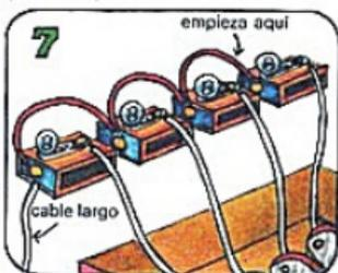
Empezando en el extremo señalado en el dibujo, une el cable libre al próximo portabombillas, como se ve en el dibujo. Une los otros dos portabombillas de la misma manera.
