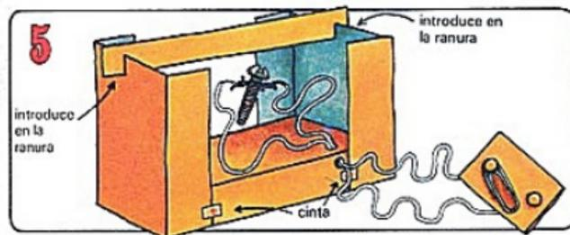
Coloca la batería en la caja y mete todo el cable dentro. Pega el extremo de abajo a la caja con cinta.
