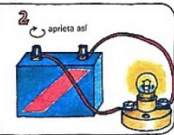
Haz un gancho en la punta del otro cable y engánchalo al segundo terminal. Se encenderá la luz. Para dejarla encendida enrósca el terminal.
