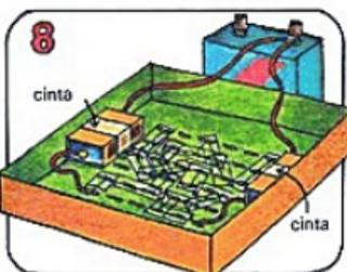
Une un cable de cada portabombillas a un pasador en las esquinas de la tapa. Enrosca los otros dos cables de los portabombillas, alrededor de una terminal de la batería.
