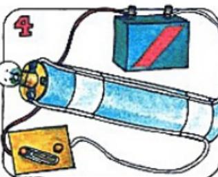
4 Enrolla el tercer cable alrededor del pasador libre sobre el interruptor. Junta el otro extremo del cable al segundo terminal de la batería.
