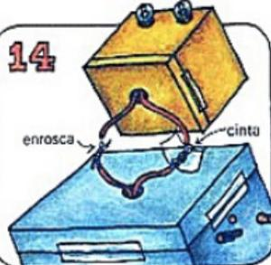
Enrosca un cable de la cabeza alrededor de uno del cuerpo. Pon una pieza de cinta adhesiva alrededor de la parte unida. Haz lo mismo con los dos otros alambres.
