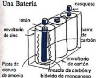
Cuando los alambres se juntan a los dos terminales de una batería, la electricidad pasa a lo largo de los alambres. Pasa desde el terminal señalado con un signo - al terminal señalado con un signo +. La electricidad puede sólo pasar cuando puede dejar un terminal y correr al otro. Esto se llama un circuito.
