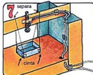
Cuelga los hilos sobre la barra que cruza. Pega las puntas de los hilos en las esquinas de la caja de fósforos con cinta. Separa los hilos para que la bandeja esté nivelada y se balancee libremente.
