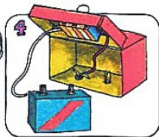
Vuélve la caja hacia la parte delantera y enrolla la punta de un cable del portabombillas, alrededor de un pasador. Une el otro cable a un terminal de la batería.
