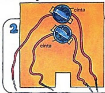
Une la punta del cable largo a cada uno de los tornillos en los cuatro portabombillas.
