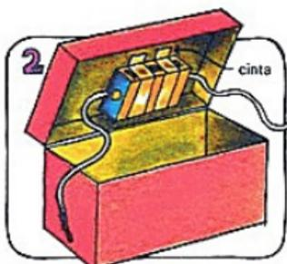
Coloca el portabombillas debajo de la tapa y empuja la bombilla hacia arriba a través del agujero. Fija el portabombillas al interior de la tapa con cinta.
