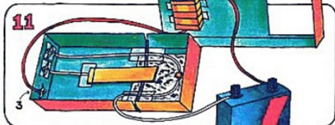
Introduce un tercer pasador junto a los Terminales 1 y 2 en el extremo de la caja. Márcalo como Terminal 3.
