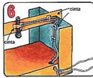
Sujeta el electro-ímán en la mitad de la barra que cruza, con cinta. Sujeta el cable a lo largo de la barra y a lo largo de la pieza de cartón.
