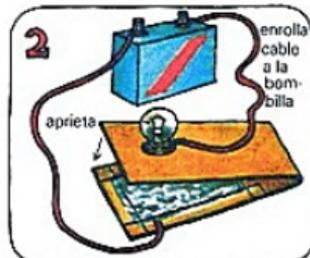
**2** Mete la bombilla en el agujero. Enrolla un extremo del segundo cable alrededor de la bombilla. Une los extremos libres de los cables a los terminales de la batería.
