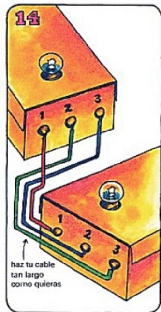
Une otro cable largo de un Terminal 2 a un Terminal 3. Coloca el tercer cable largo desde el Terminal 3 al Terminal 2. Los transmisores quedan así listos para usarse.
