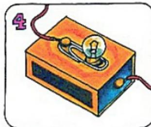
**4** Enrosca el final de una pieza de cable alrededor del pasador encima de la caja. Enrosca la otra pieza alrededor del pasador en un lado de la caja.
