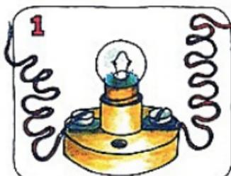
1 Une el cabo de un cable a cada uno de los tornillos que van sobre el portabombillas.
