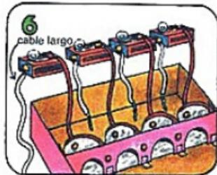
Une un cable a cada pasador en los cuatro portabombillas, poniendo un cable largo en el pasador final. Enrolla el otro extremo de cuatro cables de los fijados en el portabombillas, alrededor de cada pasador en las cuatro curvas.
