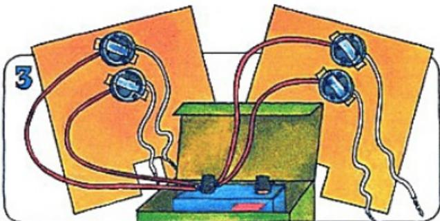
Pon la batería en la caja pequeña. Enrolla las puntas de un cable de cada uno de los portabombillas para juntarlos.
