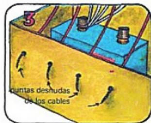
Haz cuatro agujeros en la parte delantera de la caja. Mete la punta de un cable de cada portabombillas a través de un agujero. Fija cada cable al interior de la caja con cinta.
