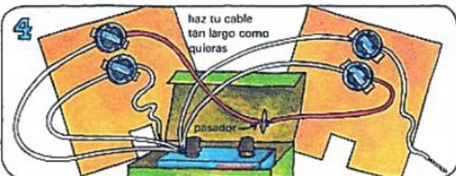
Mete un pasador a través de la tapa de la caja. Une la punta de un cable libre del portabombillas de encima y uno de un portabombillas de abajo, al pasador.
