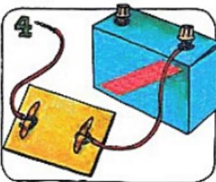
Una pieza de cable a cada uno de los pasadores del interruptor. Enrosca la punta libre de un cable alrededor de un terminal de la batería.
