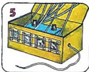
Haz un agujero en un lado de la caja. Mete una larga pieza de cable a través del agujero y une la punta desnuda al segundo terminal de la batería.
