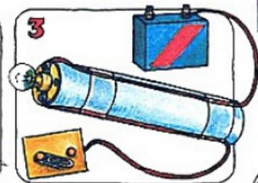
3 Enrolla el cabo de un cable del portabombillas alrededor de uno de los pasadores del interruptor. Une el otro cable del portabombillas a un terminal de la batería.
