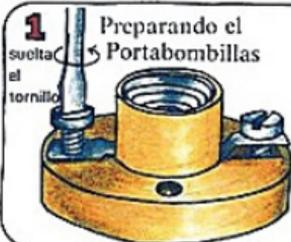
Coloca la punta de un destornillador en la ranura de uno de los tornillos. Da unas cuantas vueltas, de esta forma, pero no saques el tornillo. Destornilla los otros.
