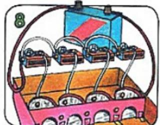
Enrosca la punta del cable largo a un terminal de la batería. Luego une el extremo de un nuevo cable largo, al pasador que está en el lado de la caja y el otro extremo al segundo terminal.
