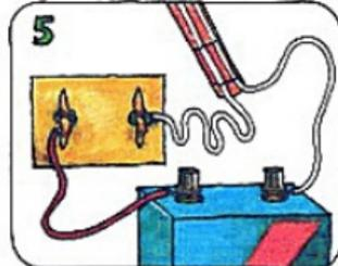
Enrolla un extremo de un nuevo cable, alrededor del pasador libre en el interruptor. Junta el otro extremo al segundo terminal de la batería. Ahora enciende la linterna.
