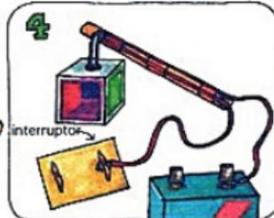
Junta un extremo de un cable del palo a un terminal de la batería. Junta el otro cable a un pasador en el interruptor.
