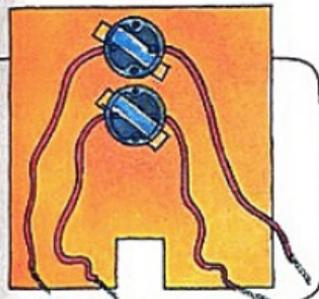
Sostén un portabombillas encima de un agujero en la cartulina y enroca una bombilla desde el otro lado. Fíjala con cinta adhesiva. Fija los otros portabombillas de la misma manera.
