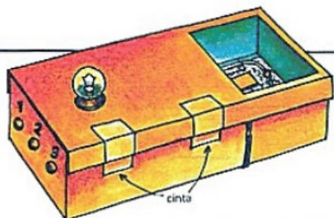
Coloca la batería en la caja y mete dentro todo el cable. Coloca la tapa encima de la caja, con el agujero por encima del conmutador. Fijala con cinta adhesiva.
