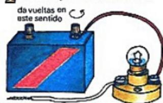
Dobla una punta de alambre en el portabombillas para hacer un enganche. Quita un terminal de la batería y engancha el alambre allí. Enróscalo otra vez.
