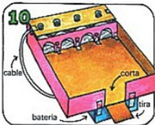
Pega con cinta la batería debajo de la caja, en el extremo donde no están los arcos para hacer una inclinación. Corta en el final de la caja una tira de 3 cms. de ancho.
