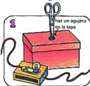
Haz un agujero en la tapa de la caja, suficientemente grande para meter la bombilla. Entrolla la punta de un trozo de cable alrededor de los pasadores del portabombillas.
