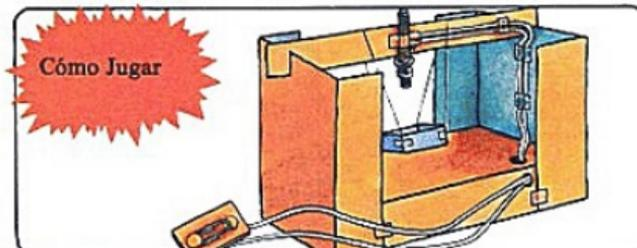
Enciende el electro-ímán y sujeta un pequeño tornillo o clavo a él. Empuja la bandeja de la caja de fósforos suavemente con tu dedo para que se balancee.
