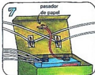
Enrosca un cable corto alrededor del tercer pasador y une la otra punta, al segundo terminal de la batería. Cierra la tapa y pégala con cinta.
