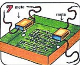
Une un cable corto a cada pasador en los portabombillas. Haz un agujero en cada lado de la tapa y mete las bombillas a través de él. Pega los portabombillas en su sitio con cinta adhesiva.
