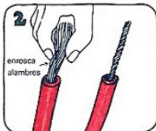
Si tu cable tiene manojos de alambres dentro del plástico, enróscalos para hacer un cabo como éste.
