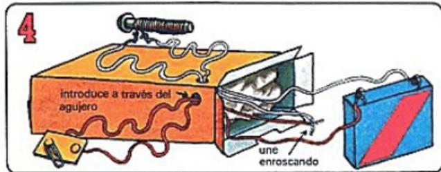
Enrosca las puntas de dos nuevos cables alrededor de dos pasadores en el interruptor. Introduce las puntas a través del agujero en un lado de la caja y sácalas hacia afuera.
