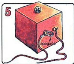
5 Enrolla una terminación de cada una de las dos piezas de cable, alrededor de los dos pasadores en la Lámparita de Noche. Asegúrate de que el interruptor del clip está apagado.
