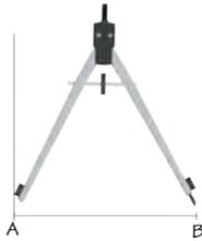
d) Con el compás marca un trazo en la parte superior de la línea perpendicular y llámalo C.
