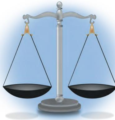
**LA BÁSCULA** es un aparato que sirve para pesar, esto es, para determinar el peso (básculas con muelle elástico) o la masa de los cuerpos (básculas con contrapeso). Normalmente, una báscula tiene una plataforma horizontal sobre la que se coloca el objeto que se quiere pesar.
