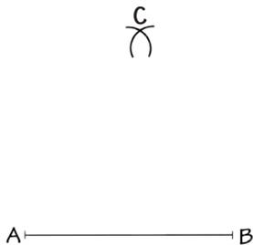
f) Une el punto C con los puntos A y B, respectivamente. Has trazado un **TRIÁNGULO EQUILÁTERO**, es decir, un triángulo que tiene sus tres lados de igual medida.
