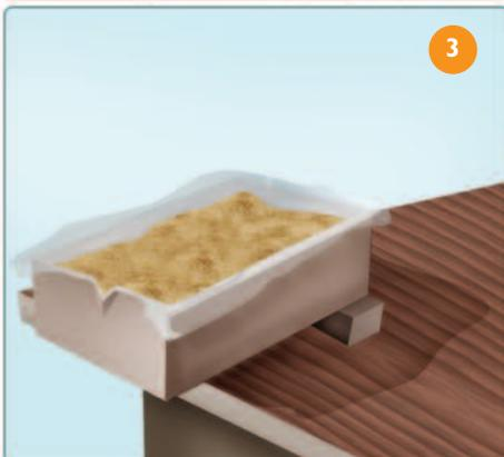
**Paso 3.** Llená con tierra seca o arena seca la caja hasta el nivel de la punta de la “V”, como indica la figura 2.
