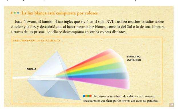
Cuando Newton hizo incidir luz blanca sobre una de las caras del prisma, observó que la luz se descomponía en siete colores distintos: rojo, naranja, amarillo, verde, azul, índigo y violeta. Este conjunto de colores de la luz se llama **espectro luminoso**. La luz se descompone debido a que cada color que contiene el rayo de luz inicial, al refractarse, se desvía en un ángulo distinto.
