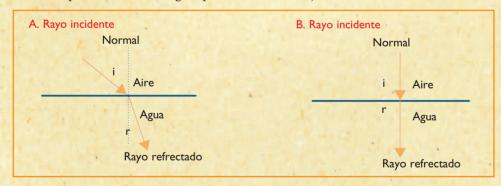
Cuando un rayo incide desde el aire en el agua se desvía al llegar a la superficie del agua y forma un ángulo llamado **ángulo de incidencia**. Al ingresar al agua, el rayo se refracta formando con la normal un nuevo ángulo llamado **ángulo de refracción**, que es menor que el ángulo de incidencia (A). Si el rayo saliera fuera del agua hacia aire, recorrería el mismo camino en sentido inverso. Sólo hay una situación en la que el rayo incidente no se desvía: cuando coincide con la normal (B).
