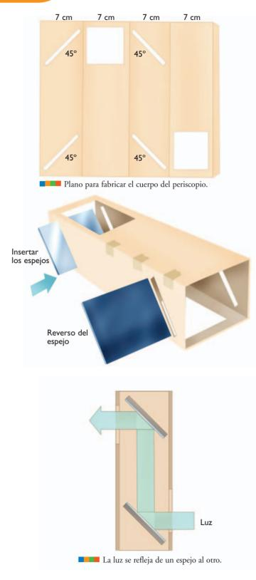
Paso 1. Para hacer el cuerpo del periscopio, necesitarás un prisma (podés usar la caja que hayas conseguido, si tiene esa forma, o fabricarlo con el esquema que figura a la izquierda). En el segundo caso, marcá con el lápiz las líneas por donde hay que doblar el cartón para formar las cuatro caras. Recortá las ventanas y las ranuras, como se muestra en el esquema, y pegá la aleta internamente contra el otro borde.
