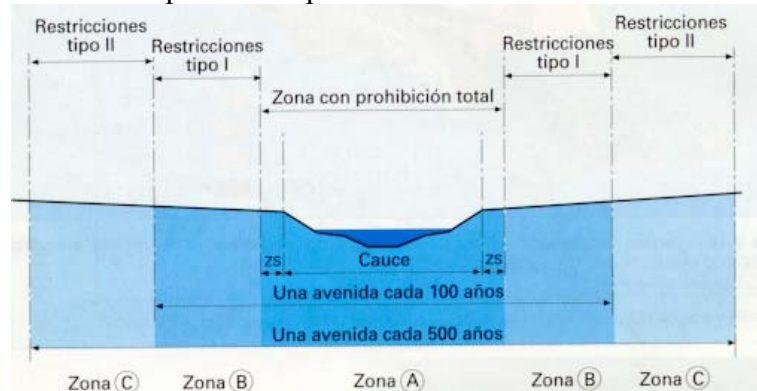
Figura 8.20. Normativa legal sobre ocupación de cauces fluviales. (Según Real Decreto 849/1986.). Una de las principales causas de los daños originados por las inundaciones se debe al incumplimiento de esta ley.
