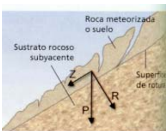
Figura 15. Fuerzas que intervienen en los deslizamientos.
