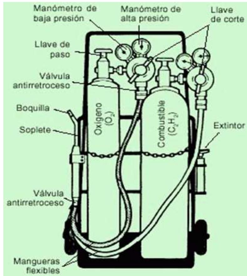
La soldadura oxiacetilénica o autógena se logra al combinar al acetileno y al oxígeno en un soplete. Se conoce como autógena porque con la combinación del combustible y el comburente se tiene autonomía para ser manejada en diferentes medios. El acetileno se produce al dejar caer terrones de carburo de calcio en agua, en donde el precipitado es cal apagada y los gases acetileno.
