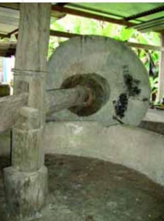
Dos piedras de forma circular con medidas 59 cm de diámetro y 15 cm de grosor. Datan de 1800. Servían para trillar café, para lo que se hacía una hera redonda de madera o cemento, se colocaba la piedra en la punta de un timón o vara, la cual se afincaba a un trozo de madera que estaba en el centro y en la hena giraba la piedra y en ella se trillaba el café. Estas ayudaban en las faenas de trabajo y también funcionaban con la fuerza del agua.
