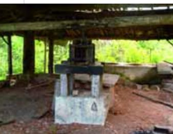
dras, la del centro se llama la malla y las otras dos, masas. Para una molida se necesitaban cuatro bueyes, que eran los animales con que se movían y se rotaban dos horas cada par. En la aldea Guacamaya, del municipio Francisco de Miranda hay otro trapiche que
