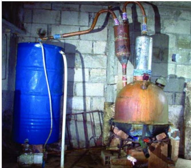
El alambique es una herramienta utilizada para destilar mezclas de líquidos mediante un proceso de calentamiento y posterior enfriamiento. Fue inventado alrededor del siglo X de nuestra era y se usa para producir perfumes, medicinas y el alcohol procedente de frutas fermentadas.
