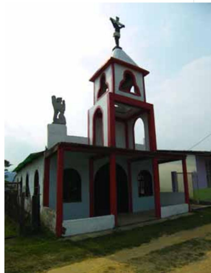
Tiene más de 40 años de construida. Es de forma rectangular, con techo de dos aguas con acerolit y estructura de madera. Posee una entrada principal con puerta de madera tallada y a sus lados dos ventanas de madera y vidrios de forma arqueada. A cada lado posee cuatro ventanas con las mismas características que las frontales. En la parte frontal posee una torre
