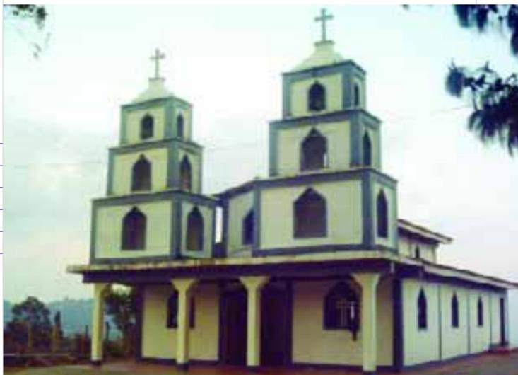
chada tiene una puerta de acceso y dos ventanas, una a cada lado, todas las ventanas laterales, tres de cada lado, y los vanos en las torres tienen forma pentagonal. Los materiales de construcción son cemento, acero, arena, madera, vidrio y el techo a dos aguas es de concreto con cubierta de tejas a manera de decoración.
