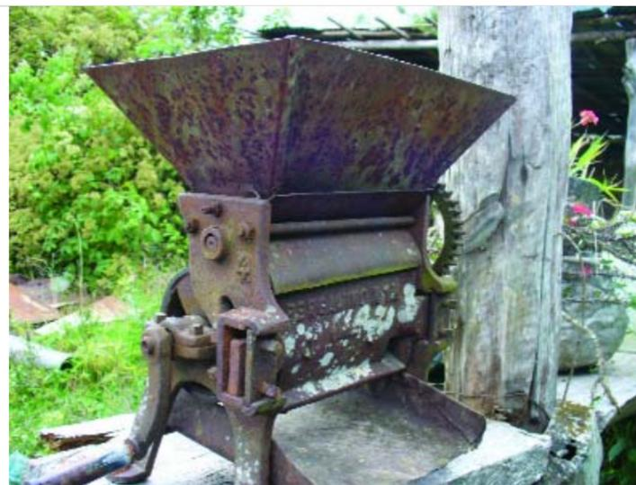
salen por el lado izquierdo del cilindro, mientras que el grano despulpado es recolectado en un tobo colocado en la parte inferior del cilindro. Pueden ser tanto manuales como a motor. Son objetos muy estimados en las comunidades agrícolas y productoras de café.
