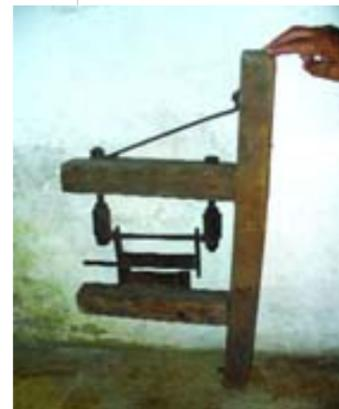
El fique es una planta de la que se obtiene una fibra para realizar tejidos. Este artefacto servía para procesarlo. Está realizado en madera y metal. El proceso consistía en cortar la penca verde *jecha*, pasarla por la máquina y luego poner a secar los hilos a la sombra y finalmente tejer los hilos del fique hasta terminar las piezas como mochilas, tendales –donde poner a secar café, trigo, frijol– y costales empleados en labores agrícolas.
