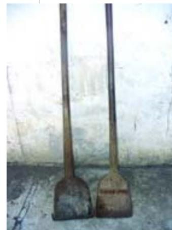
Estos utensilios son especies de palas de madera de 1,70 cm de largo aproximadamente. Se realizaban con madera de la zona que fuese fuerte para que perduraran. Eran empleados en la fabricación de las paredes de tapia y su función específica era pisar la tierra para lograr la consistencia y firmeza de la construcción.
