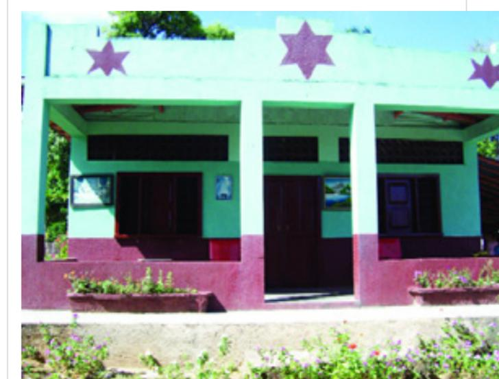
Es una de las primeras casas de la localidad realizada en 1948. Su disposición es en planta rectangular, de un solo nivel. La fachada principal, con vista hacia el este, posee dos ventanas con protección de rejas de hierro y dos más en cada una de las fachadas laterales. También muestra un alero soportado por canes de madera. El techo es a dos aguas cubierto por láminas de acero. El acceso principal lo
