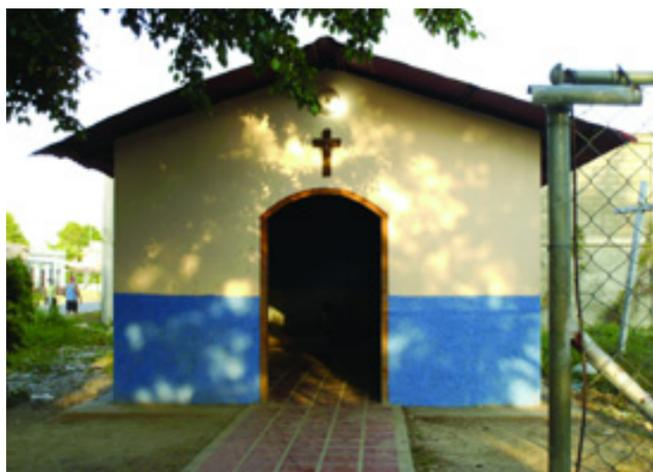
La estructura original fue derribada en 1963, para edificar la actual en el mismo sitio. Presenta planta rectangular con dimensiones de cuatro metros de ancho por siete metros de largo. Fue construida con bloques y concreto, posee en la fachada aberturas con bloques de ventilación, y un único acceso. En su alrededor posee áreas verdes, donde se celebran los velorios de la Cruz de mayo.
