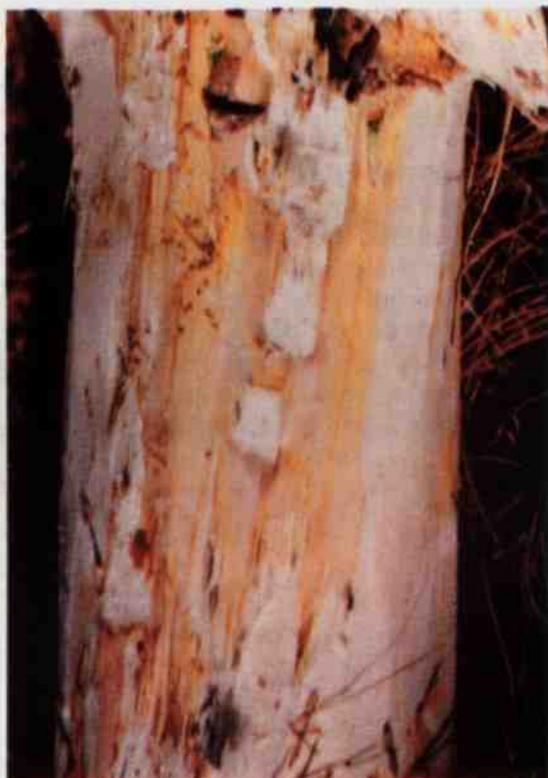
Fig. 6. Obsérvese la distribución del colorante fucsina y nigrosina en un ejemplar de *Cupressus* sp.
