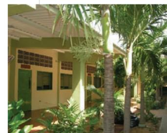
Edificación escolar de construcción moderna que presenta características propias de las escuelas rurales de nuestro país. Esta edificación está compuesta por módulos separados en estructura de concreto, con paredes de bloques, puertas y ventanas metálicas, mientras que en la parte superior de la pared de cada salón
