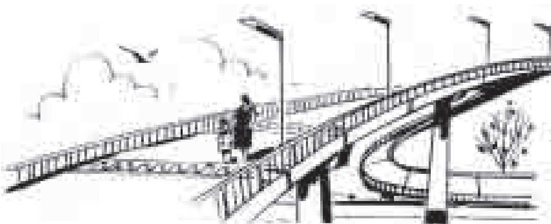
Figura 22. La dilatación de los cuerpos se aplica en la construcción de vías, puentes y demás estructuras.
