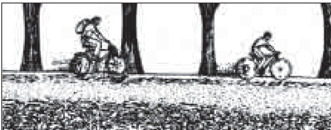
Figura 27. Si el punto de referencia se toma en uno de los árboles, el ciclista de la derecha se mueve a 30 km/h. Si el punto de referencia lo tomamos en el ciclista de la izquierda, el de la derecha se aleja de este ciclista a 10 km/h. El movimiento de un cuerpo depende del punto de referencia que se escoja.
