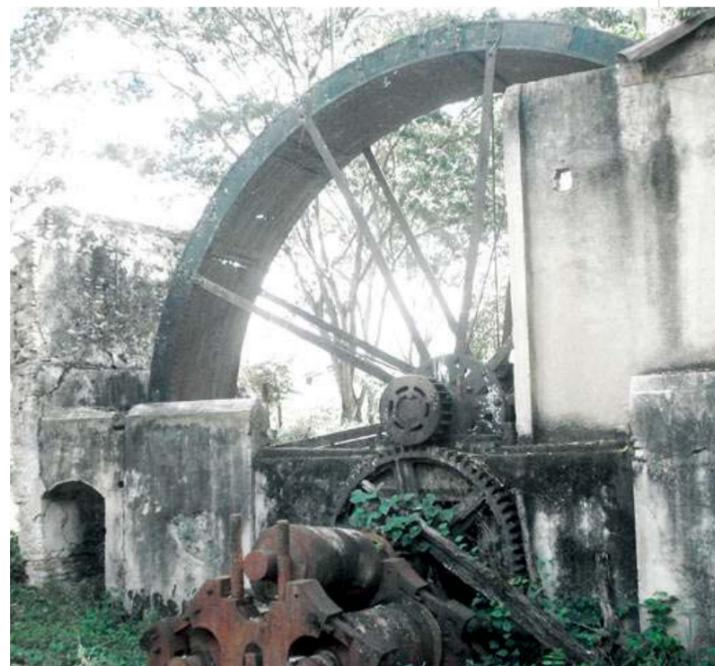
cionamiento de la noria consiste en una gran rueda con aletas transversales que se coloca parcialmente sumergida en un curso de agua, el cual, gracias a las aletas, imprime a la rueda un movimiento continuo. Ésta posee en su perímetro una hilera de recipientes —usualmente cangilones— que con el movimiento de la rueda se llenan de agua, la elevan y la depositan en un conducto asociado a la noria que la distribuye.
