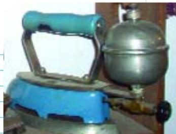
Integrada por 6 planchas antiguas, monedas y 9 moldes papeloneros. Tres planchas son de hierro macizo y eran colocadas en una lámina grande calentada al rojo vivo por brasas de carbón, que calentaba a su vez la plancha para poder emplearla en alisar ropa; una plancha que funcionaba a gasolina, con sus respectivas válvulas y reguladores; y por último, dos planchas eléctricas, en metal y plástico, con su sistema de resistencias que la hacían calentar por alimentación eléctrica.
