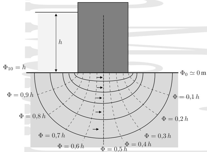
Figura 5-13 Red de flujo en una presa de gravedad con su base al nivel del suelo. Las superficies equipotenciales se muestran con líneas de trazos y las líneas de flujo con líneas continuas.
