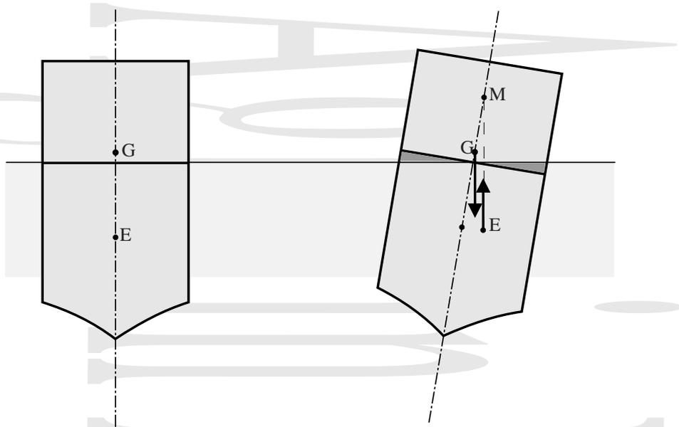
Figura 2-8 Estabilidad de un cuerpo semisumergido.
