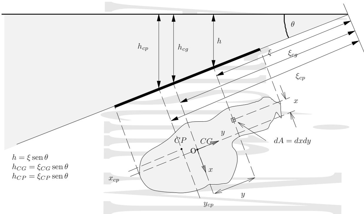
**Figura 2-5** Cálculo de la fuerza sobre una superficie plana. Consideramos una superficie plana que forma un ángulo  $\theta$  con la superficie libre del líquido.
