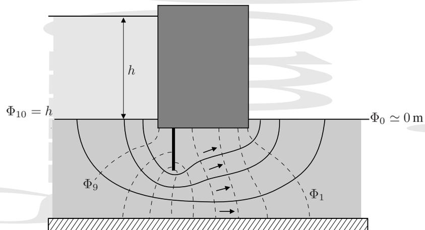
Figura 5-14 Red de flujo en una presa de gravedad ligeramente enterrada y con una pantalla impermeable y una base impermeable a una cierta profundidad.
