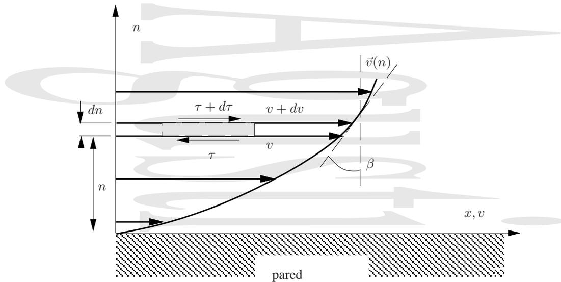
**Figura 4-3** En un fluido real en movimiento aparecen fuerzas viscosas de rozamiento  $\vec{F}_{roz}$  entre las distintas capas del fluido, con una fuerza por unidad de superficie  $\tau$ . Esto hace que la velocidad en una sección del fluido no sea uniforme.
