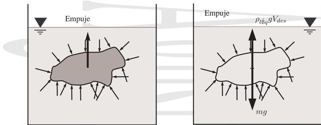
Figura 2-6 Flotación y principio de Arquímedes.
