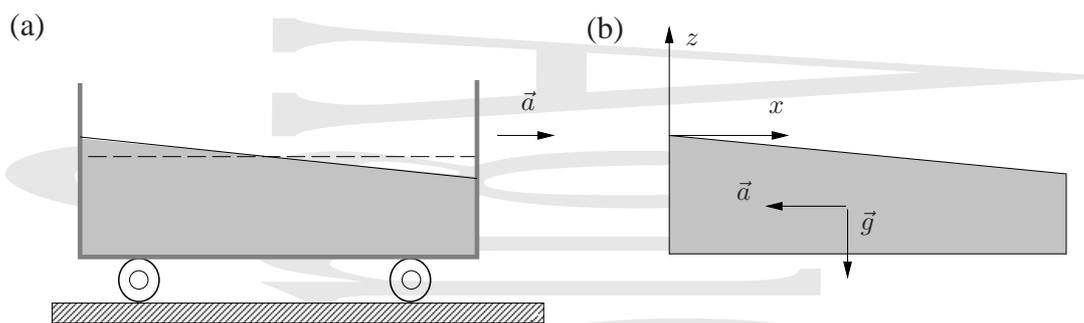
**Figura 3-7** Se tiene un depósito que se mueve con una aceleración  $\vec{a}$  (a) y se quiere saber la distribución de presiones en el líquido y la ecuación de la superficie libre. Visto el problema desde el sistema de referencia no inercial que se mueve con el depósito (b), sobre éste y su contenido actúa una fuerza ficticia igual a  $-\vec{a}$  además de la fuerza gravitatoria.
