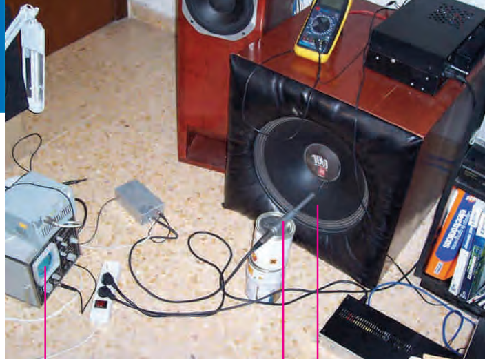
Osciloscopio Micrófono Corneta de sonido
