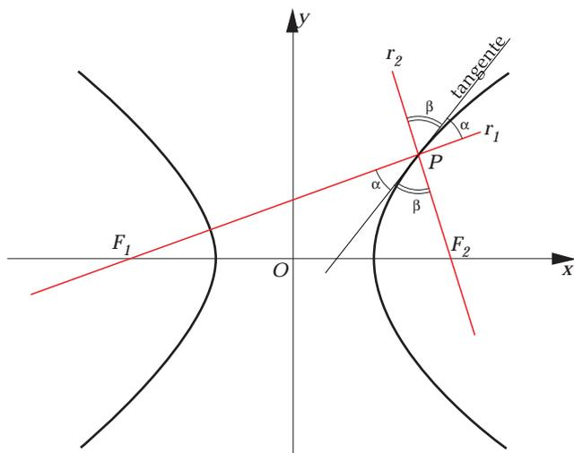
Tracemos la recta tangente a la hipérbola en un punto  $P$ . Tracemos las rectas  $r_1$  y  $r_2$  que unen a  $P$  con los focos  $F_1$  y  $F_2$  de la hipérbola. Los ángulos  $\alpha$  y  $\beta$  que forma la recta tangente en  $P$  con las rectas  $PF_1$  y  $PF_2$  son iguales. Así, la tangente es bisectriz del ángulo entre las rectas  $r_1$  y  $r_2$ .
