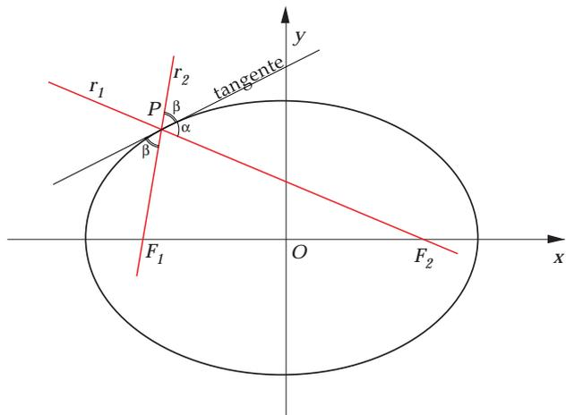
Tracemos la recta tangente a una elipse en un punto  $P$ . Tracemos las rectas  $r_1$  y  $r_2$  que pasan por  $P$  y cada uno de los focos  $F_1$  y  $F_2$ . La recta tangente a una elipse en un punto  $P$  forma ángulos iguales ( $\alpha = \beta$ ) con las rectas que pasan por los focos. Así la tangente es bisectriz del ángulo entre  $r_1$  y  $r_2$ .
