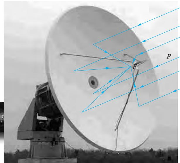
Antena parabólica para la recepción de señales.
