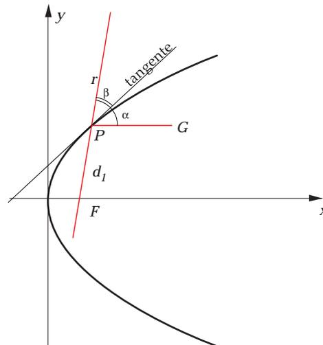
Tracemos la recta tangente a la parábola en un punto  $P$ . Tracemos la recta que une a  $P$  con el foco  $F$  de la parábola y la recta  $PG$  que pasa por  $P$  y es paralela al eje de simetría  $x$  de la parábola. Los ángulos  $\alpha$  y  $\beta$  que forma la recta tangente en  $P$  con las rectas  $PF$  y  $PG$  son iguales. Así, la tangente es bisectriz del ángulo entre las rectas  $r$  y  $PG$ .
