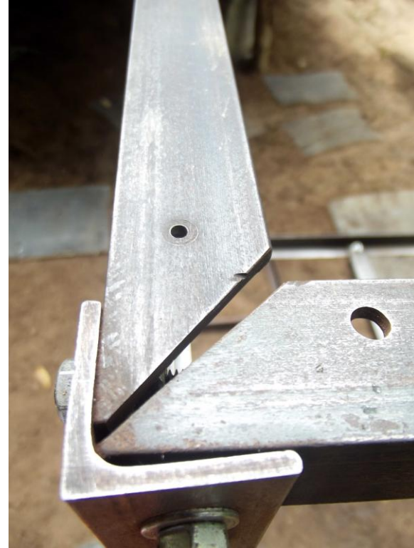
Ángulos metálicos antes y después de retirar el óxido con lijas para poder pintar el metal.
