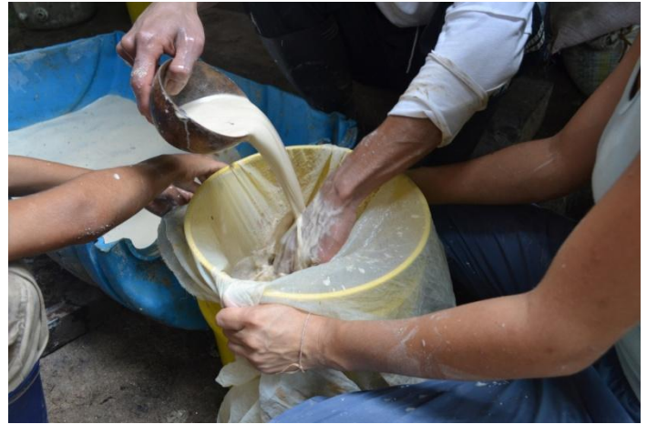
Mezcla y disolución para ayudar al paso del agua arcillosa
