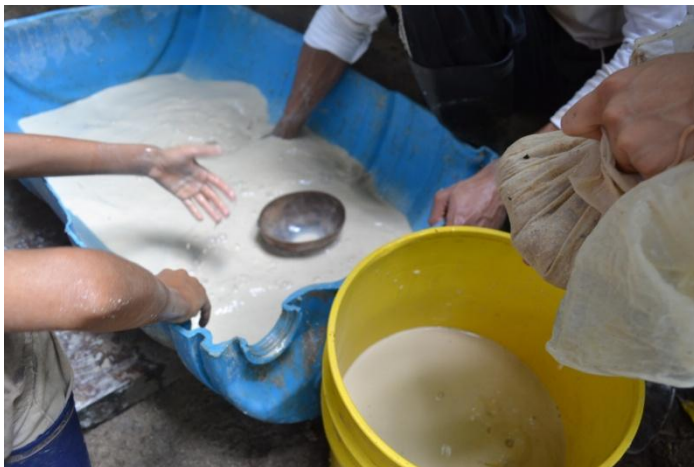
Escurredo del agua arcillosa que aun se encuentra impregnada a la piedrilla
