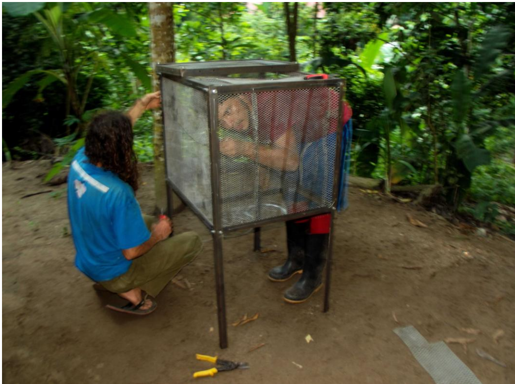
Sujeción de la malla metálica a la estructura del horno con alambre de acero
