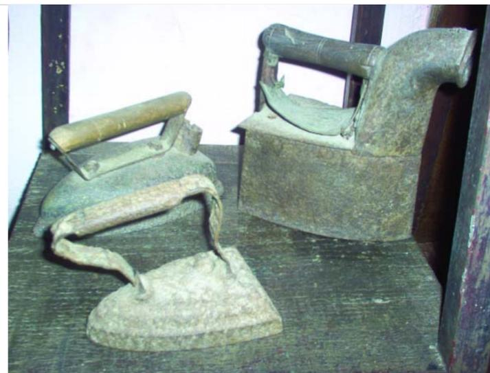
Las planchas de hierro tienen una base de forma triangular lisa en su parte inferior y un asa o mango curvo para su manipulación. Eran calentadas al fogón directamente sobre la brasa o sobre parrilla o budare, a altas temperaturas para realizar el planchado; en los hogares siempre habían varias porque era necesario tener más de cuatro calentando a la vez.
