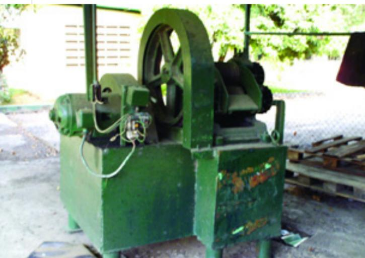
Un trapiche es un molino que sirve para extraer el jugo de algunos frutos de la tierra, como la aceituna o la caña de azúcar. Está conformado por una estructura de madera con techo en lámina de acero, la cual resguarda espacio, ma-
