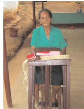
Instrumento que se utiliza para elaborar la capellada de las alpargatas. Consiste en una mesa de madera sobre la cual se posa un triángulo metálico, encargado de halar uno de los peines de donde se sujeta la trama de hilos que permiten que suba y baje el peine. En la parte superior tiene una madera en forma de V abierta en la puntas.
