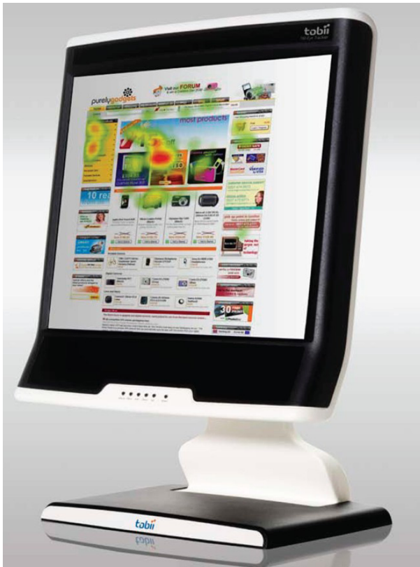
Como se puede apreciar, las cámaras de rayos infrarrojos pasan desapercibidas por el usuario, al quedar ocultas en la zona inferior del monitor. Fuente: Tobii.
