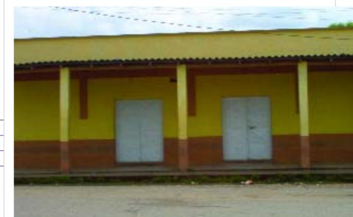
Es una construcción de mediados del siglo XX edificada en bloques rojos con friso liso, en el frente tiene un pasillo con seis pilares de concreto y techo de asbesto, vigas de made-
