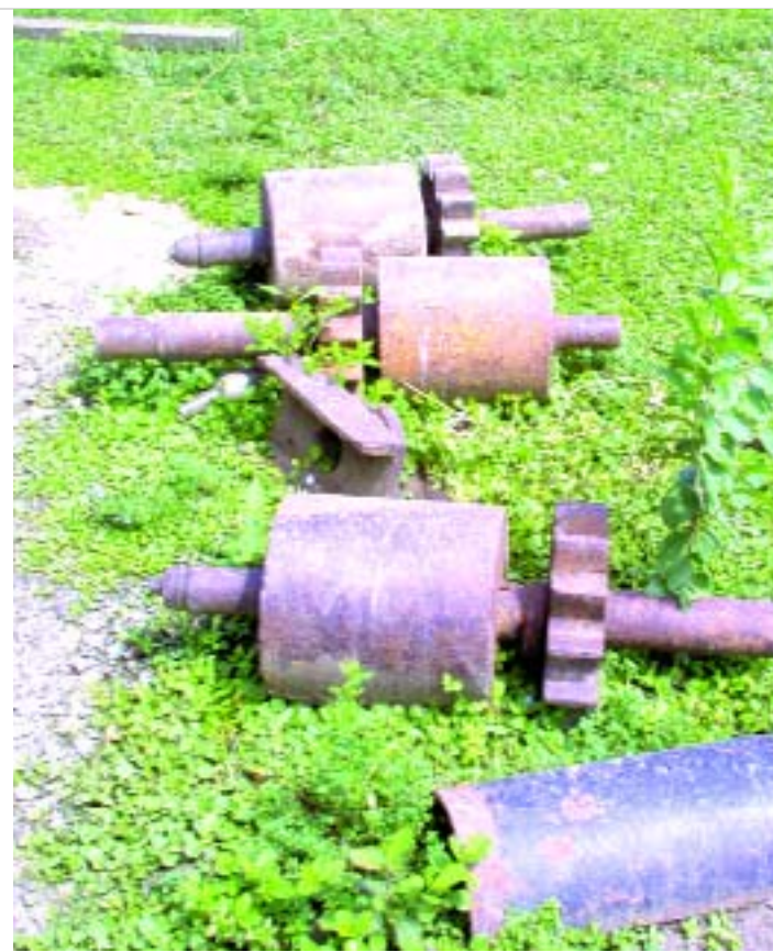
chagui-chagui o rudimentario, ubicándose como el primer artefacto tecnológico en la obtención del jugo de caña.
