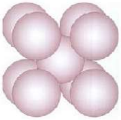
Celda unidad de la estructura cúbica centrada en el cuerpo
