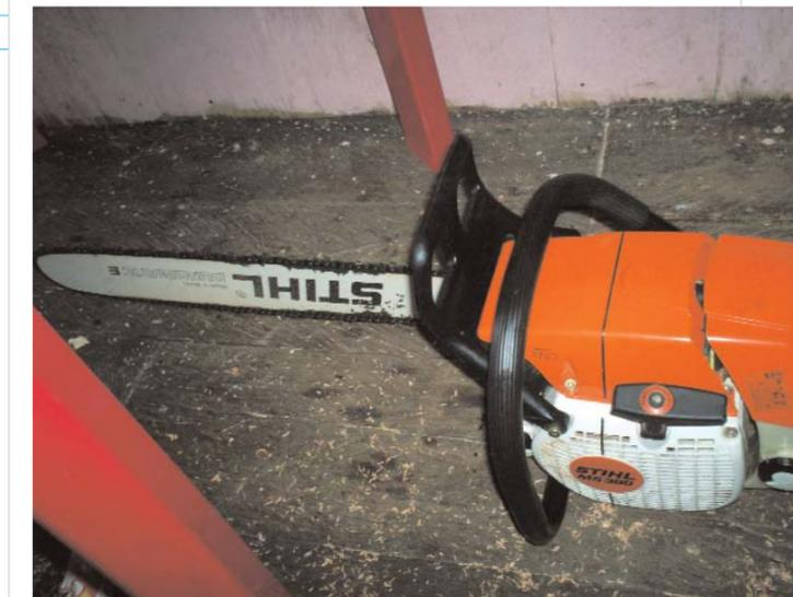
Instrumento metálico y de motor usado en la época contemporánea con el fin de talar árboles en los bosques de modo más rápido que con la tradicional hacha. En el delta es de uso cotidiano por los constructores para cortar los troncos del árbol de carapo y peramancillo para hacer tablas para la construcción de palafitos.
