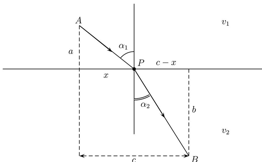
En la figura, hemos representado esquemáticamente un rayo de luz que va del punto  $A$  al punto  $P$ , con una velocidad  $v_1$ , y luego, pasa a un medio más denso, del punto  $P$  al punto  $B$ , con una velocidad inferior,  $v_2$ .
