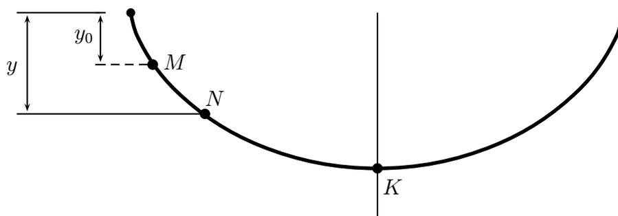
Imaginemos una pista “cicloidial” y una bola metálica que rueda por ella (despreciamos la fricción).
