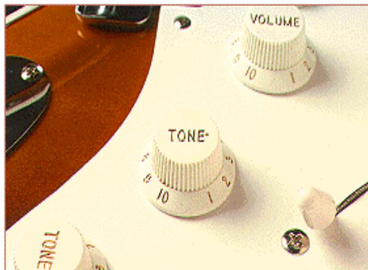
**E**L CONTROL DE VOLUMEN se usa para ajustar el nivel de salida de la guitarra. Los controles de tono determinan los niveles de agudos y graves. En algunas guitarras, los controles afectan a toda la señal. En otras, cada pastilla tiene su propio control de volumen y tono.
