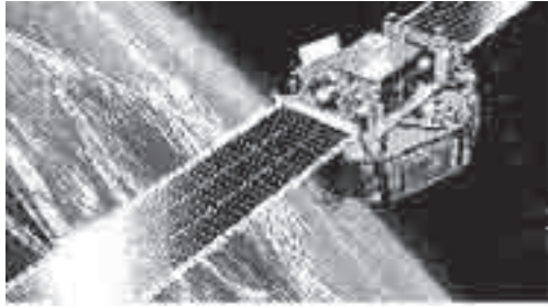
Figura 21. Los paneles solares producen electricidad que es utilizada en el funcionamiento de los satélites.
