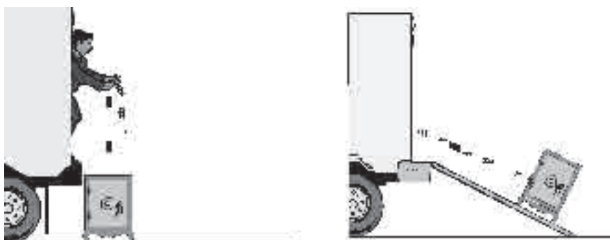
Figura 21. La fuerza mínima requerida para levantar la caja de seguridad hasta el camión es menor si se utiliza un plano inclinado.
