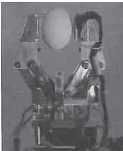
Figura 19. La mano robótica es capaz de realizar la delicada tarea de recoger un huevo y sostenerlo sin que se rompa. Un sensor de matriz táctil situado en la mitad derecha de este mecanismo envía información a la computadora de control del robot acerca de la presión que debe ejercer la mano robótica. Con esta información el ordenador de control envía instrucciones a la mano robótica para que afloje, apriete o mantenga la fuerza de agarre que aplica en un determinado momento. Este bucle de retroalimentación se repite continuamente permitiendo que la mano robótica se mantenga entre los dos extremos: o dejar caer el huevo o aplastarlo.
