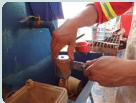
Medición de la densidad del lodo. Fuente: Archivo del MPPE (2012).
