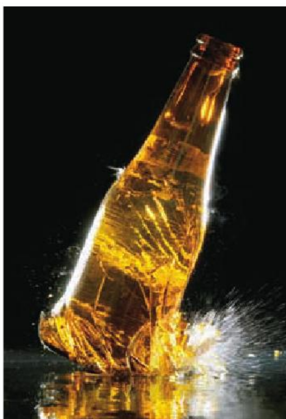
El impacto de la botella sobre la superficie dura provocó el rompimiento del vidrio en fragmentos en el punto de impacto, generando grietas que se extienden rápidamente por el resto de la botella.
