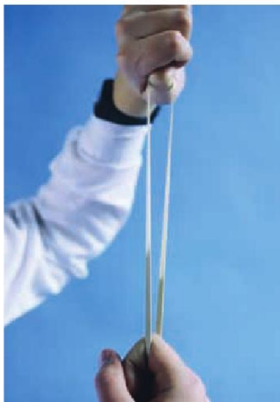
Cuando se aplica una fuerza a una banda elástica, la extensión de la banda es proporcional a la fuerza de estiramiento. Si se duplica la fuerza, la extensión de la banda será del doble.
