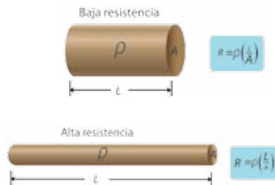
Figura 14.4. La resistencia eléctrica disminuye con el área y aumenta la longitud.
