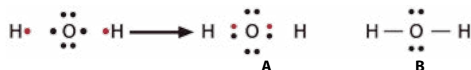
Figura 7.4. Representación del enlace covalente simple de la molécula de agua, a través de la estructura de Lewis (A) y estructura de Kekulé (B).
