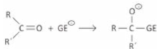
Figura 11.17. Ecuación general de reacciones de adición.
