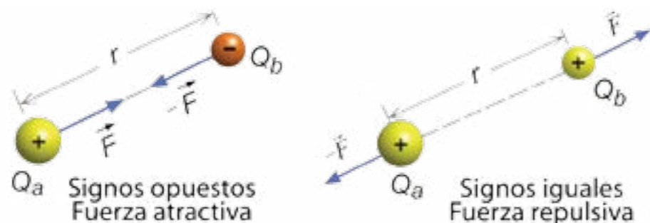
Figura 12.5. Fuerzas entre dos cargas Q_a y Q_b , separadas por una distancia r , que interaccionan en el vacío.
