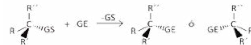
Figura 11.13. Ecuación general de reacciones de sustitución.
