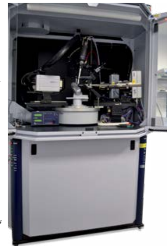
Figura 9.1. Aparato de difracción de rayos X: es una técnica muy utilizada para determinar la distribución espacial de los átomos en una molécula.
