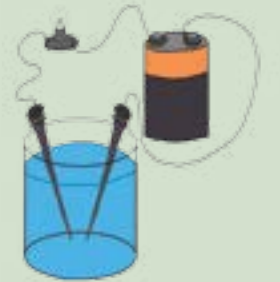
Figura 7.20. Montaje del equipo para determinar la conductividad eléctrica.
