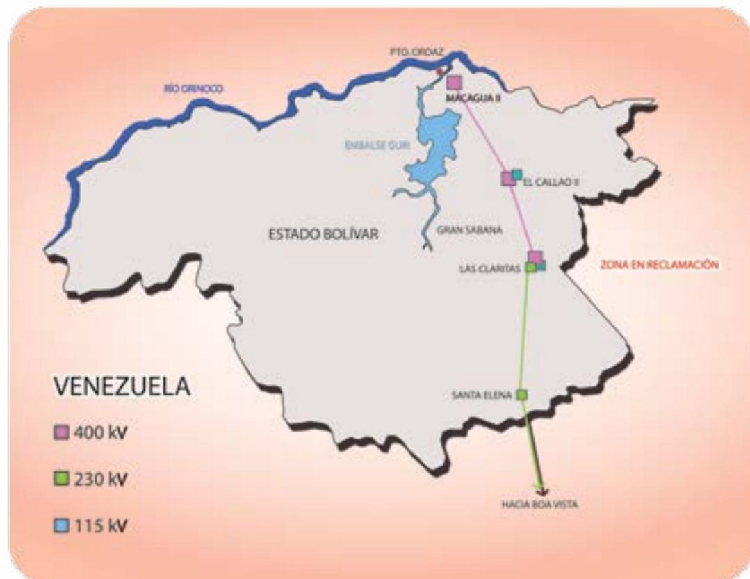
Figura 3.13. Una de las líneas de transmisión de la electricidad de Macagua II y la variación de la tensión a lo largo del camino en las subestaciones.
