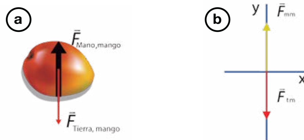
Figura 12.13. a) Fuerzas que actúan sobre el mango b) Diagrama de cuerpo libre (D.C.L.) de las fuerzas que actúan sobre el mango. Te darás cuenta de que en este caso todas las fuerzas parten de un mismo lugar, que corresponde a un punto idealizado llamado “centro de masa”, colocado en el origen del sistema de coordenadas. A las fuerzas que parten de ese punto se les suele llamar concurrentes .
