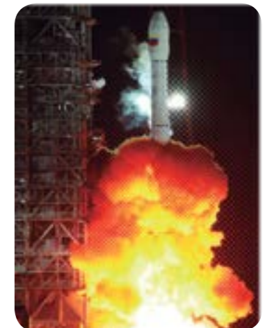
Figura 12.8. (a) Modelo del cohete Larga Marcha 3b, cuya masa puede ser considerada constante si se usa como juguete y lo movemos de un lado a otro. (b) Fotografía del lanzamiento real del cohete que llevaba el satélite "Simón Bolívar" al espacio, en este caso la masa del cohete no puede considerarse constante ya que la expulsión de gases y combustible de su interior es lo que hace posible su propulsión.
