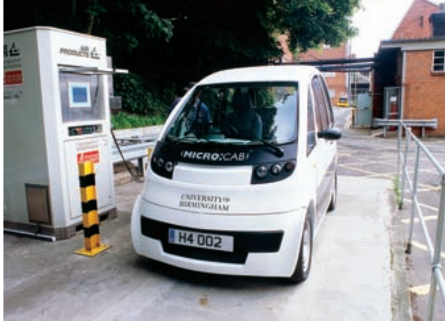
Un coche eléctrico carga combustible en una gasolinera de hidrógeno. Las células del combustible de hidrógeno se combinan con el oxígeno del aire para crear electricidad.
