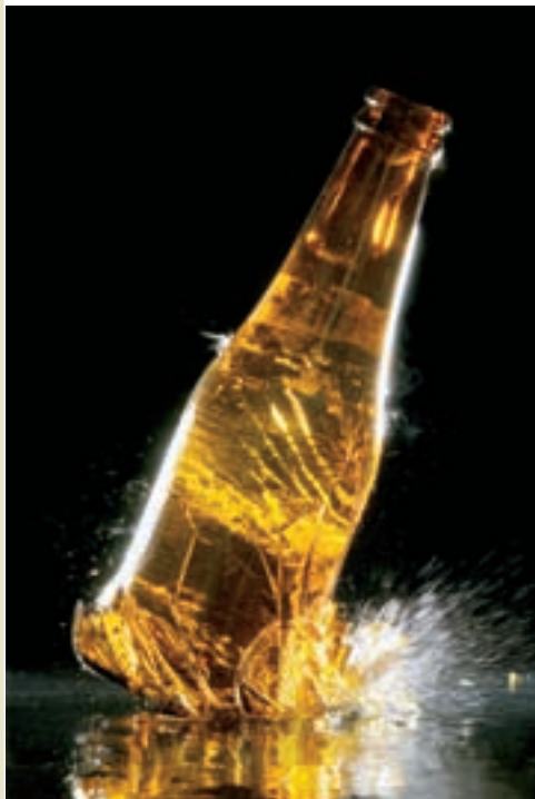
El impacto de la botella sobre la superficie dura provocó el rompimiento del vidrio en fragmentos en el punto de impacto, generando grietas que se extienden rápido por el resto de la botella.
