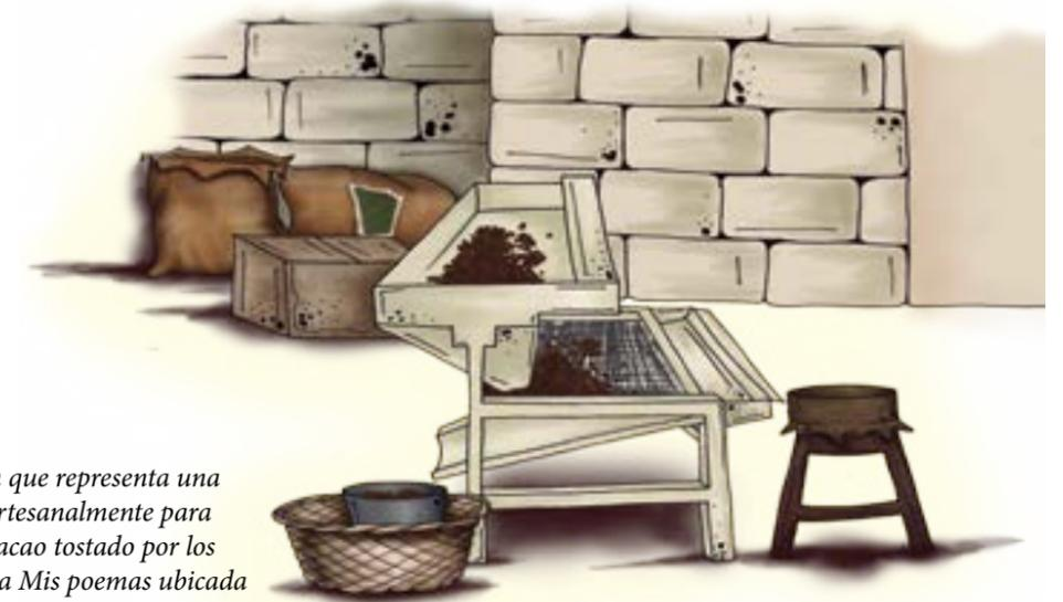
*Figura 12.1 Ilustración que representa una máquina construida artesanalmente para el descascarillado del cacao tostado por los productores de la hacienda Mis poemas ubicada en Barlovento, estado Miranda.*
