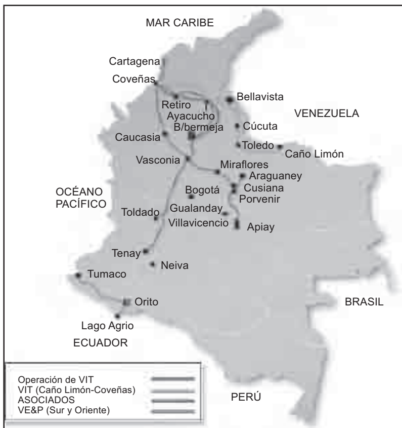
La red de oleoductos del país transporta el crudo hacia los puertos o hacia las refinerías.
