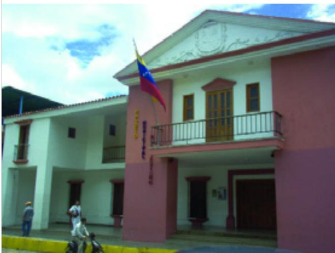
Se trata de una edificación de dos plantas que ocupa una amplia parcela. Fue construida en estructura de concreto armado, paredes de broques frisados, puertas y ventanas de madera, metal y vidrio. En su fachada principal destaca un gran frontón triangular con el escudo del estado, y debajo de éste un amplio balcón corrido con baranda de hierro hacia el cual
