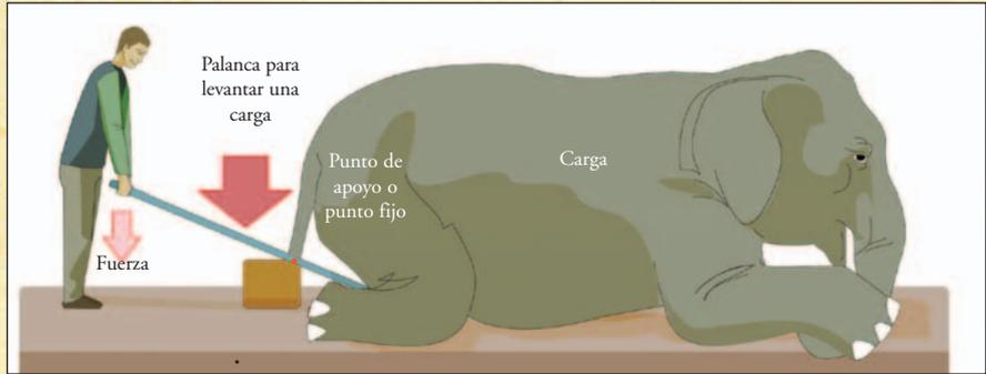
El trabajo (fuerza x desplazamiento) que se realiza en un extremo es igual al trabajo que se realiza sobre la carga en el otro y extremo
