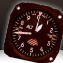
El altímetro es un instrumento de precisión que permite determinar la altitud de un lugar.
