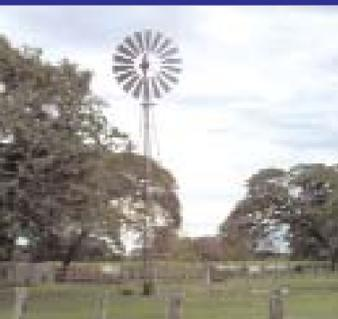
hierro con ángulos de una y dos pulgadas. En la parte superior poseen tornillos, pernos y un aspa de dos metros de diámetro con un motor de poleas. Al girar las aspas se pone en funcionamiento el motor que hace hundir la varilla en el pozo para extraer el agua hacia la superficie. Los molinos de viento son valorados en la comunidad para la extracción de agua en los lugares donde no existen acueductos y así obtener el vital líquido tanto para consumo humano como animal.
