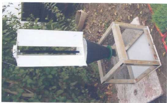
Foto 5.2. Trampa fototrópica, que atrae a los insectos voladores por acción de la luz.
