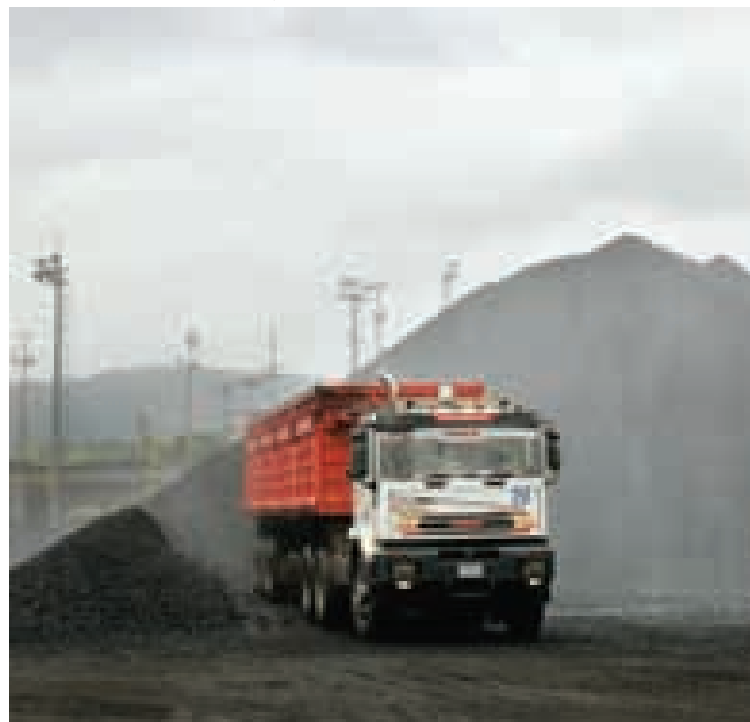
Mina Paso Diablo. Ubicada al norte del estado y operada por la compañía Carbones del Guasare, esta mina forma parte del yacimiento carbonífero más importante del país. Aquí la explotación del carbón se realiza a cielo abierto. Una vez extraído, el mineral es triturado y transportado en camiones hasta el terminal de embarque.
