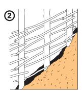
Encañado: Consiste en una estructura armada con palos delgados, ramas largas y arbustos que se atan de un horcón a otro. Las cañas se unen con bejucos o alambres, en sentido horizontal. Generalmente se tejen por el exterior e interior de lo que será la vivienda, dejando un cajón o espacio entre los horcones.
