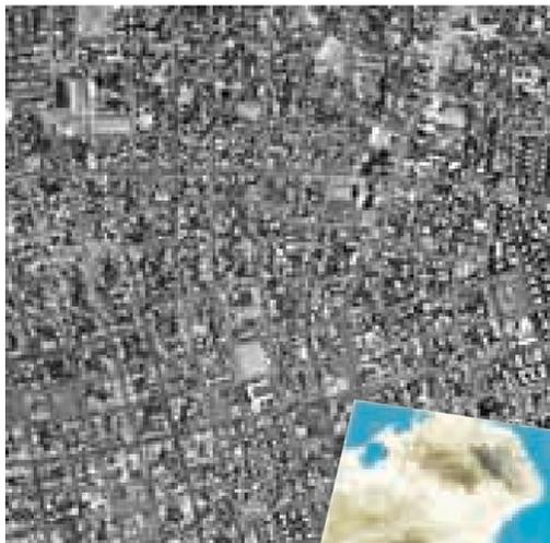
Las fotografías aéreas se captan desde un avión con cámaras de gran tamaño y alta resolución. Por su precisión, recogen una información fiel del terreno y ofrecen datos que son traducidos mediante la fotointerpretación a partir de una imagen tridimensional que se logra a través de la estereoscopia.
